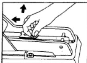
2. Вложите в механизм подходящие скобки горизонтально или наклонно.
