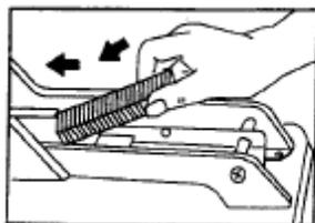
3. Надавите и вставьте толкатель в механизм, пока он не сядет на два выступа.
